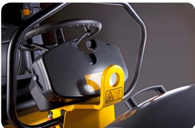
Прочная центральная подъёмная проушина упрощает и ускоряет процесс погрузки.
