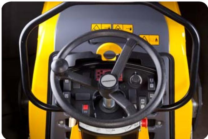
Понятная приборная панель с указателем уровня топлива. Низкий уровень вибрации рабочей платформы.
