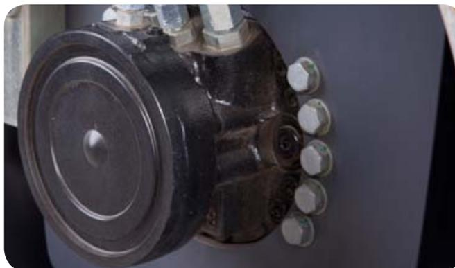
Отказоустойчивые тормоза на обоих вальцах (или на вальце и колёсах), автоматически активируются при остановке двигателя или возникновении неисправности.
