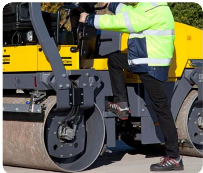
Прочные поручни и эргономичные ступеньки повышают безопасность при посадке в машину.
