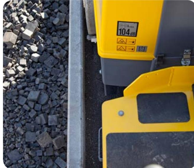
Завышенные боковые опоры и обзорность периферии вальцов, за счет выступления их краев за пределы рамы катка, обеспечивают удобство работы возле высоких бордюров. Хороший контроль процесса уплотнения благодаря отличному обзору области возле вальцов.
