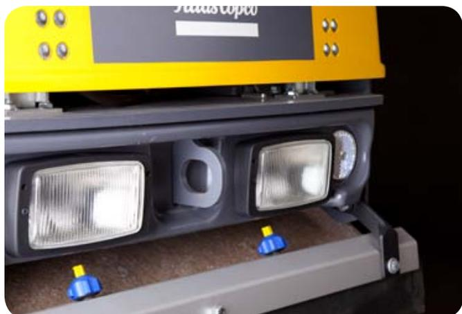
Система орошения под давлением с мощным водяным насосом и автоматически опорожняемыми магистралями.
