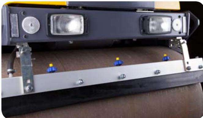
Система орошения с под давлением мощным водяным насосом и автоматически опорожняемыми магистралями.
