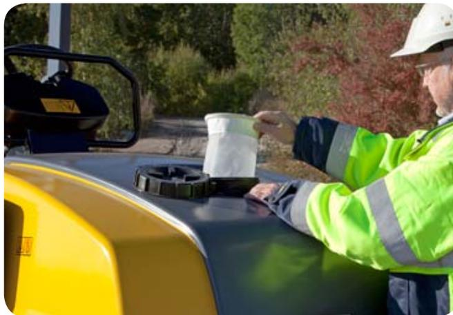
Большая горловина с заливным сетчатым фильтром упрощает заполнение бака.
